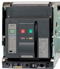
DW931系列船用框架断路器（以下简称断路器）适用于交流50Hz或60Hz，额定工作电压690V及以下的船舶电力系统中，用作发电机保护、电能分配、用电设备和线路的过载、短路和欠电压保护以及在正常工作条件下不频繁接通和断开电路。断路器具有隔离功能。断路器不带过电流脱扣器，可用作负荷开关。
